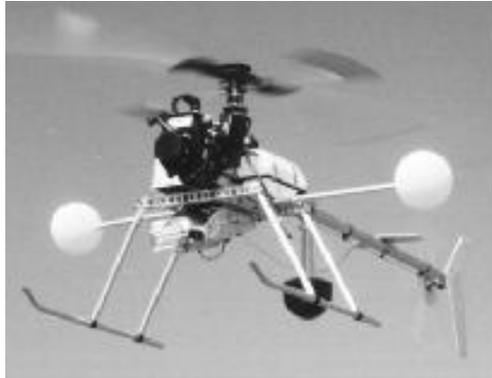
Zur besseren Erkennbarkeit hat der Fotohubschrauber seitliche Ausleger mit orangefarbenen Kugeln die am hellen Himmel gut zu sehen sind. Das hohe Landegestell ermöglicht einen Start mit senkrecht nach unten stehender Kamera.
