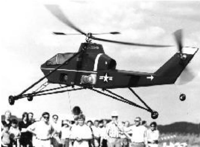
Weltrekordflug am 20.6.1970 in Altdorf bei Nürnberg. Links seitlich ist deutlich der Zusatztank zu erkennen.
