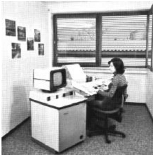
Der erste „Computer“ 1976 in einem klimatisierten Raum mit antistatischem Bodenbelag. Das offene Fenster durfte eigentlich nicht sein.
